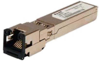
Die Unterstützung einer Datenrate von 10/100/1000 Mbit/s über Strecken von mehr als 100 Metern mit UTP-Kabeln der Kategorie 5/5e macht das robuste Transceiver-Modul SFP-1GBT-05 ideal für die Implementation in kleinen Netzwerkkarten (NICs) und Uplinks. Als solches ist es geeignet für den Einsatz in Anwendungen mit hoher Packungsdichte wie LAN 1000BASE-T, Switch-zu-Switch-Schnittstellen, geschaltete Backplanes, Blade-Server, Spielkonsolen und Router/Server-Schnittstellen.
